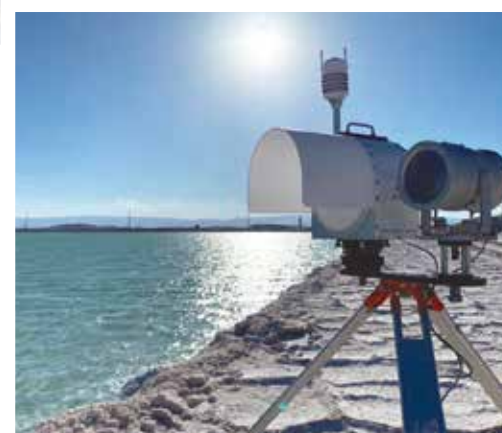
El profesor Suárez investiga la evaporación, mediante el sistema de medición de calor sensible y latente Optical Microwave Scintillometer , instalado en el Salar del Huasco (en la foto) y en el Salar de Atacama (foto a la derecha).
