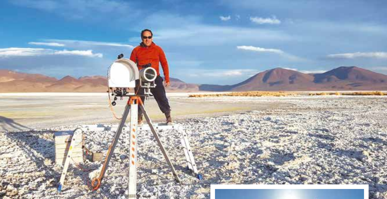
El profesor Suárez investiga la evaporación, mediante el sistema de medición de calor sensible y latente Optical Microwave Scintillometer , instalado en el Salar del Huasco (en la foto) y en el Salar de Atacama (foto a la derecha).
